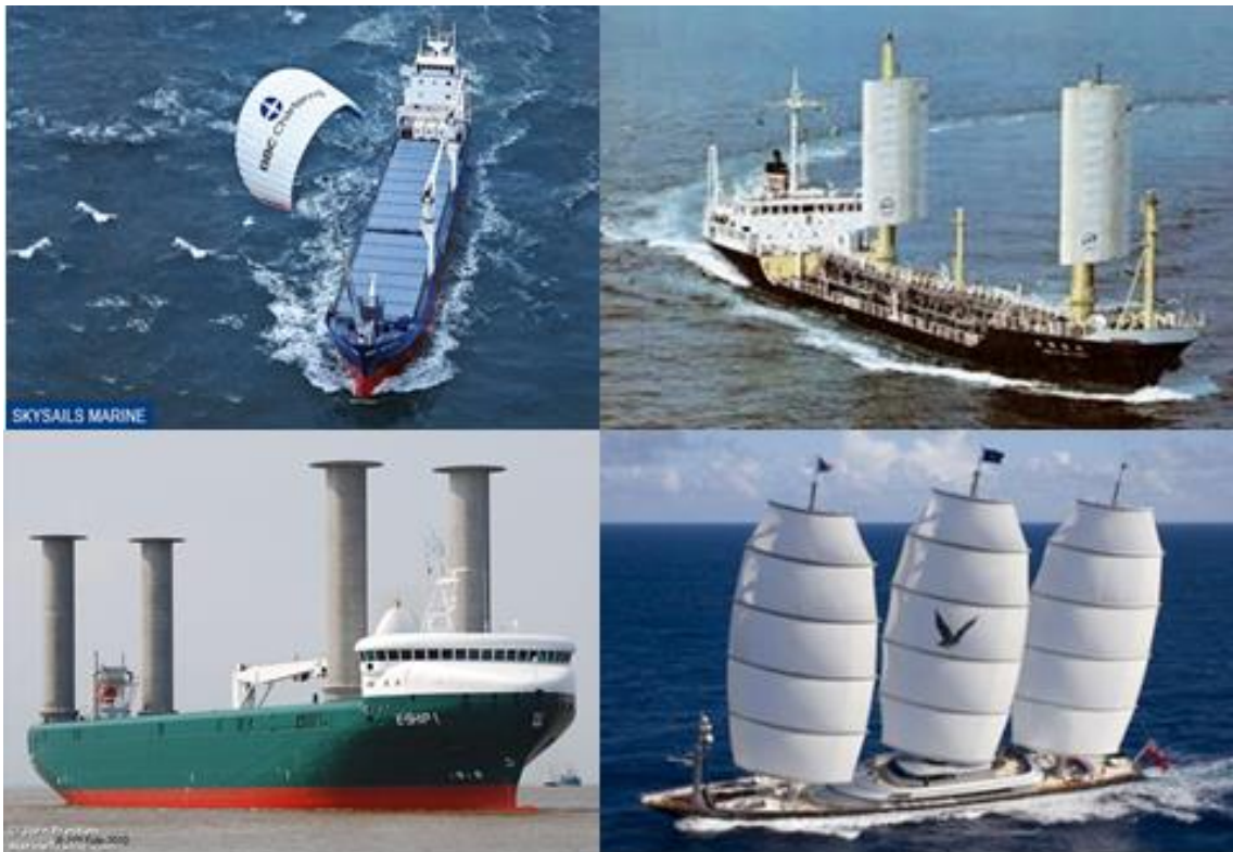
Abbildung 5.12: Die betrachteten Windzusatzantriebe: ein Kite (links oben, http://www.skysails.info/deutsch/skysails-marine/ ), ein Flettner-Antrieb (links unten, http://www.marinetraffic.com/en/photos/of/ships/shipid:151866/#forward ), ein starres Segel (ähnlich Dynarigg, rechts oben http://de.wikipedia.org/wiki/Shin_Aitoku_Maru ), und das Dynarigg (rechts unten, http://www.decaboyachtpainting.com/?project=maltese-falcon&lang=de )
